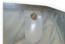
Fixation sur le toit relevable par boutons-pression
